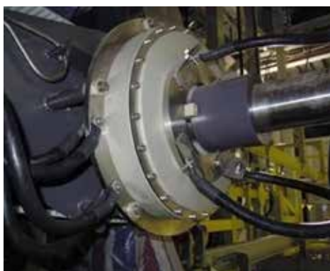
Elektroforézises festő-berendezésekben lévő csúszógyűrűs áramszedők
